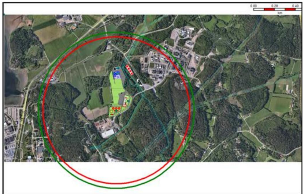
Figur 35 Möjligt påverkansområde för gasmolnsexplosion för stabila väderförhållanden (2 m/s, stabilitetsklass F). Röd ring = 0,21 bar(g), grön ring = 0,14 bar(g)
