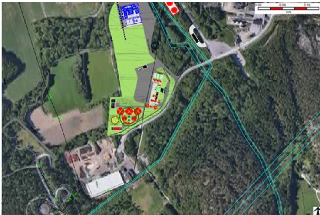
Figur 6-22: Övertrycket från en BLEVE i biogasanläggningen. Grön ring = 0,14 \text{ bar(g)} , röd ring = 0,21 \text{ bar(g)} .
