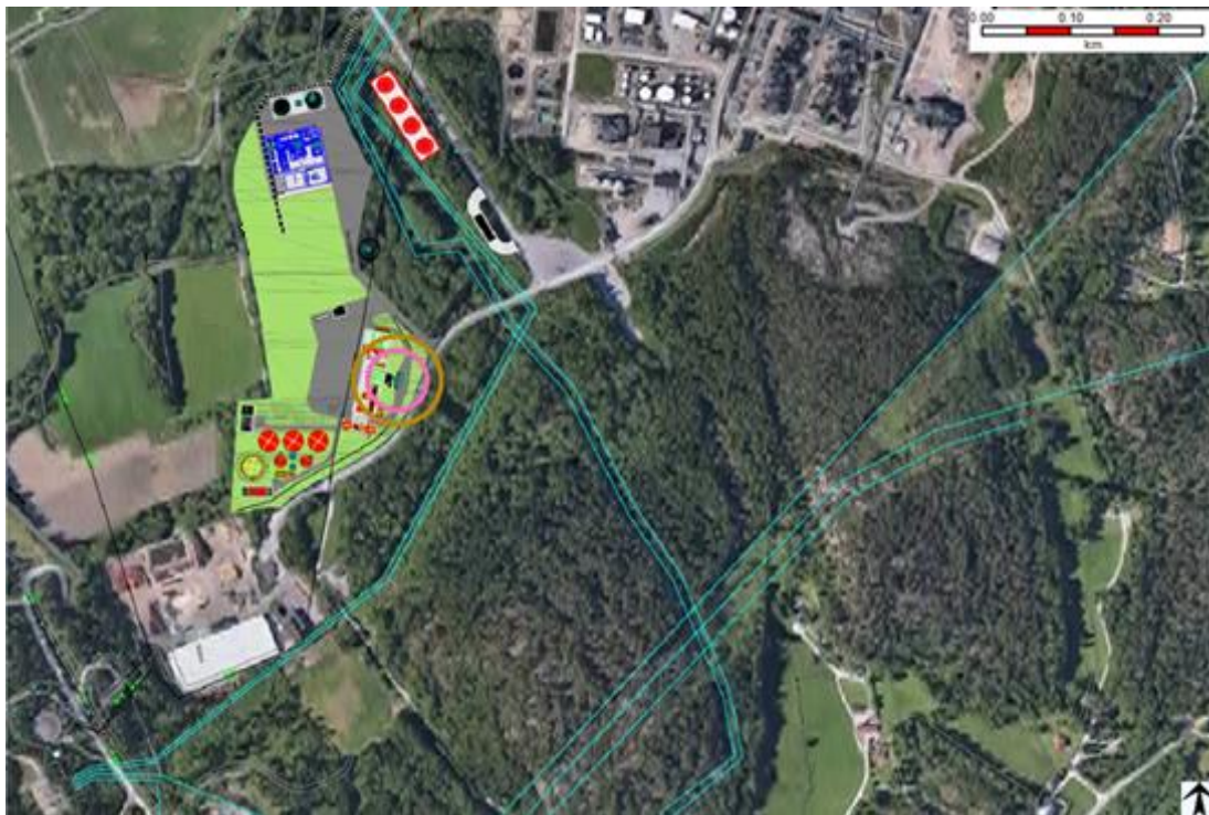
Figur 6-11: Möjligt påverkansområde för jetbrand för väderförhållande 5/D. Orange ring = 6 kW/m 2 , rosa ring = 37,5 kW/m 2 .
