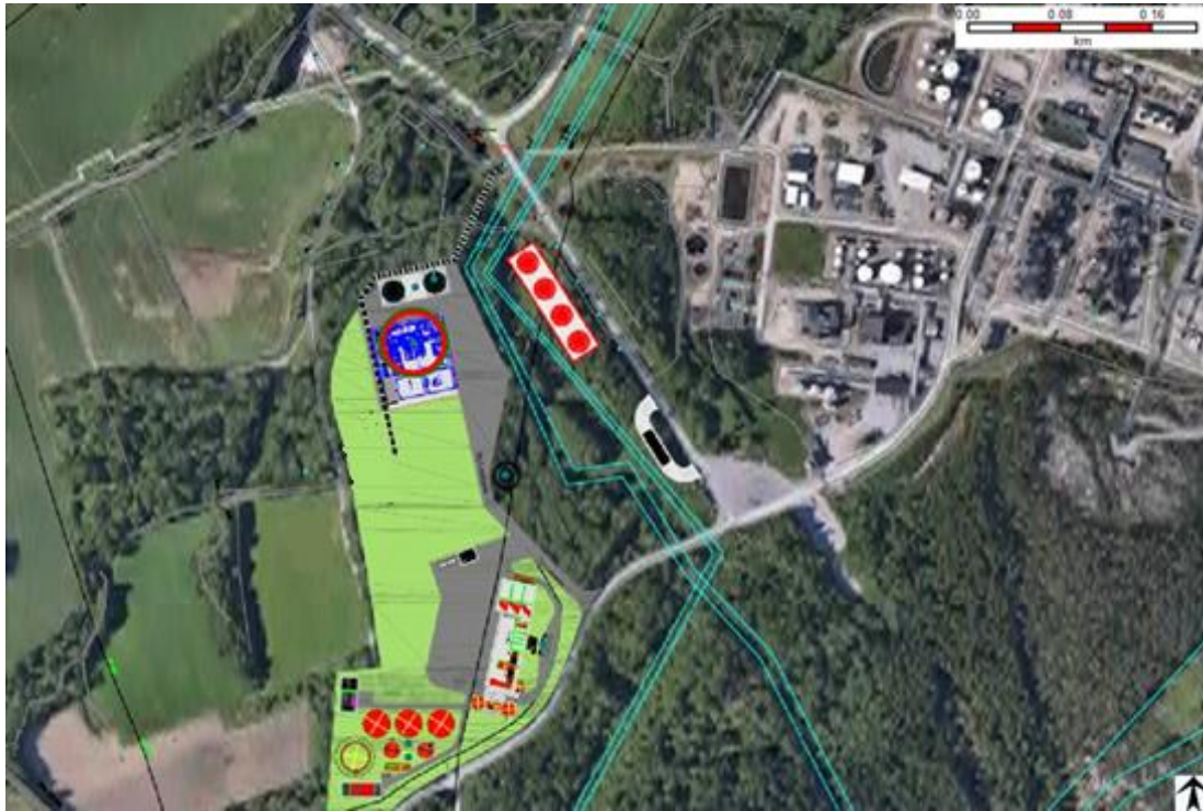
Figur 6-34: Möjligt påverkansområde för gasmolnexplosion för väderförhållande 2/F. Röd ring = 0,21 bar(g), grön ring = 0,14 bar(g).
