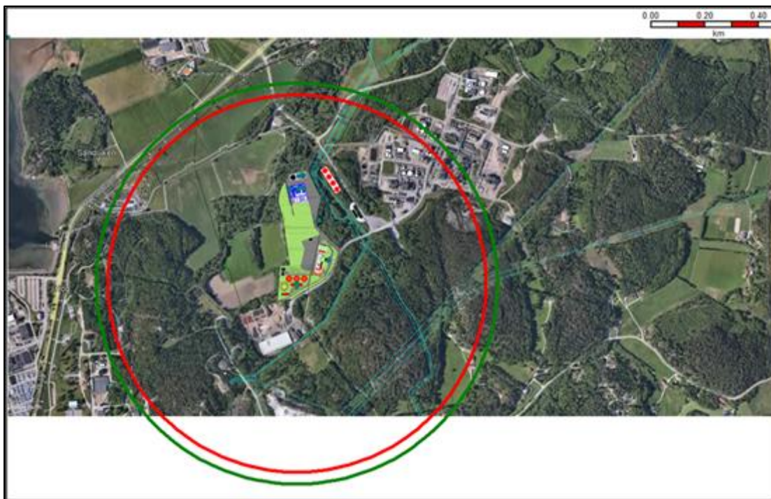
Figur 6-13: Möjligt påverkansområde för gasmolnexplosion för väderförhållande 2/F. Röd ring = 0,21 bar(g), grön ring = 0,14 bar(g).
