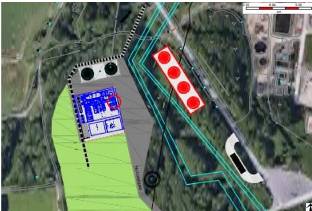
Figur 6-33: Möjligt påverkansområde för jetbrand för väderförhållande 2/F och 5/D. Endast avstånd till 6 kW/m 2 redovisas i figuren och båda väderförhållandena leder till samma resultat varför det inte är möjligt att särskilja resultaten i figuren.
