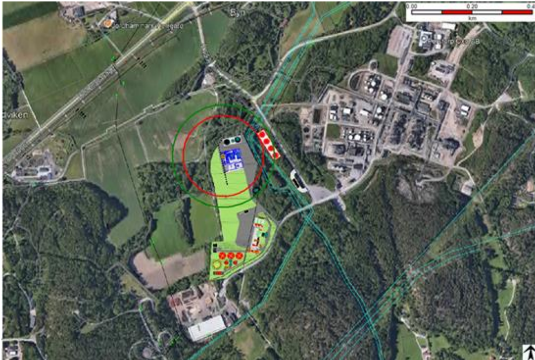
Figur 6-46: Övertrycket från en BLEVE i etenanläggningen. Grön ring = 0,14 bar(g), röd ring =0,21 bar(g).
