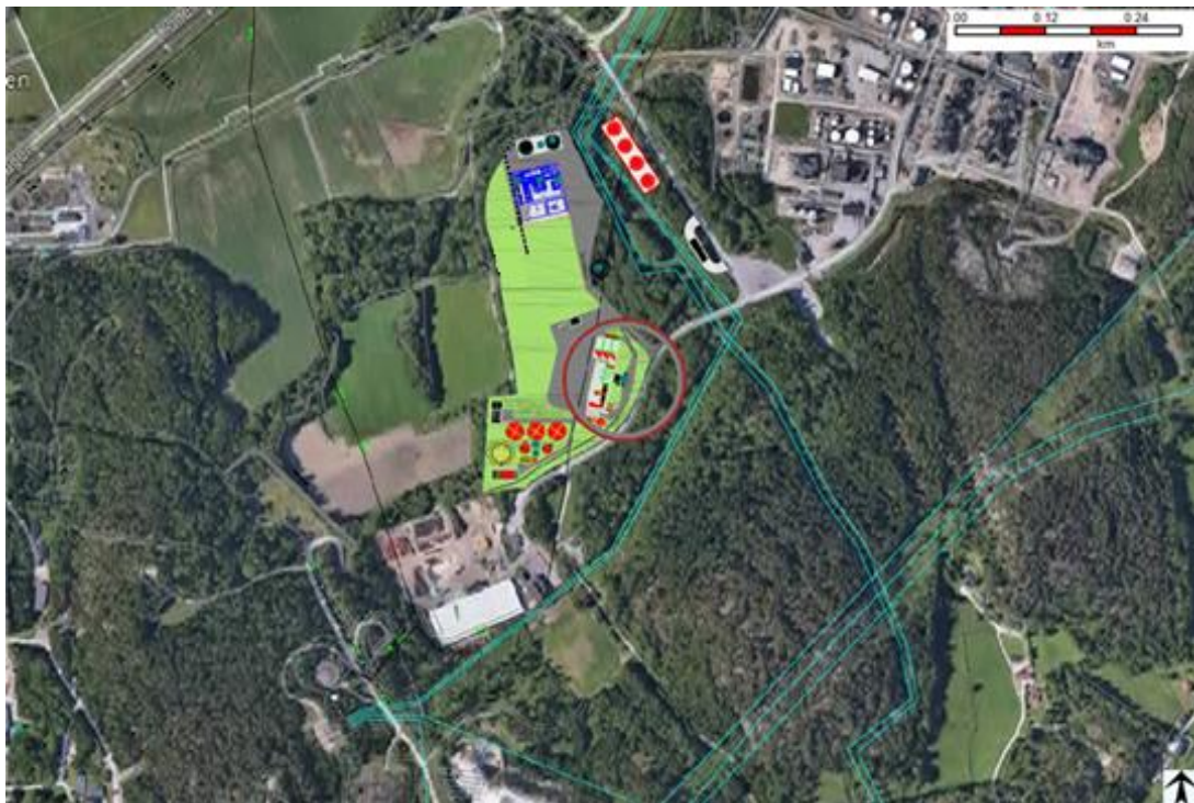
Figur 6-5: Möjligt påverkansområde för gasmolnsexplosion för väderförhållande 5/D. Grå ring = 0,21 bar(g), röd ring = 0,14 bar(g).
