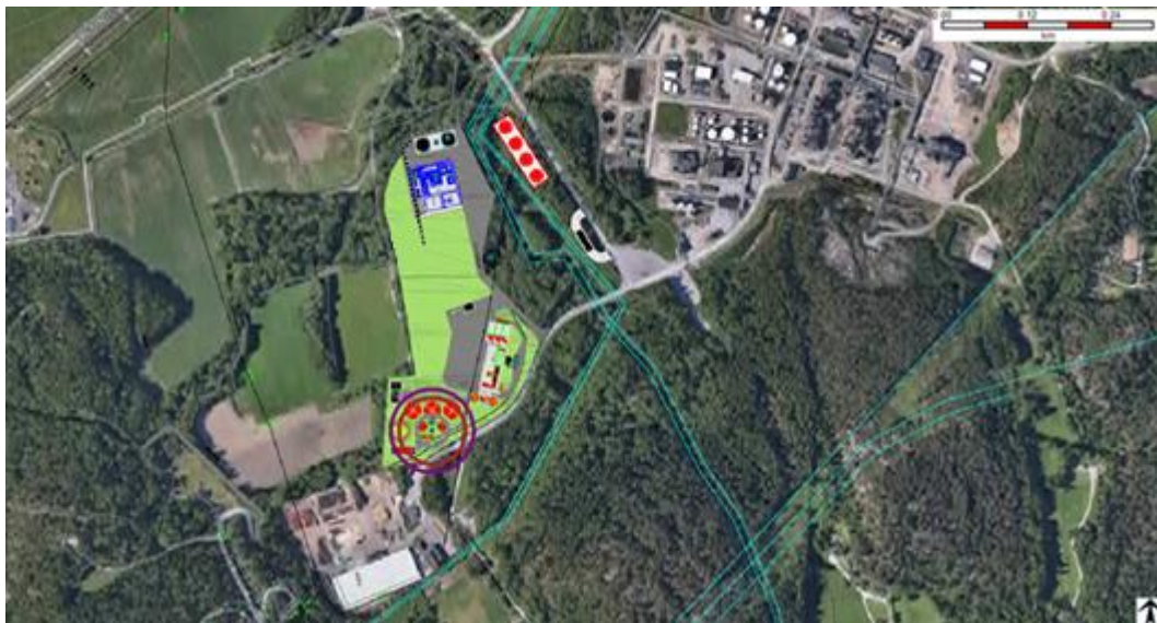
Figur 6-27: Beräknat avstånd till olika fraktioner av dödsfall vid väder 5/D. Lila ring = 0,1%, röd ring = 1 %, grå ring = 10%.
