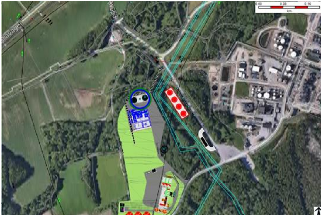
Figur 6-30: Påverkansområdet för pölbrand i invallning för väder 2/F och 5/D. I figuren visas endast avstånd till 37,5 kW/m 2 . Grön markering = 37,5 kW/m 2 vid väder 5/D, blå markering = 37,5 kW/m 2 vid väder 2/F.
