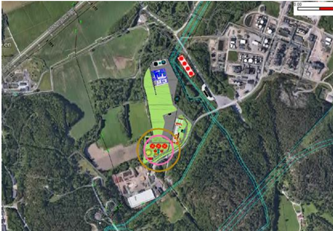
Figur 6-16: Möjligt påverkansområde för pölbrand för väderförhållande 5/D. Orange ring = 6 kW/m 2 , rosa ring = 37,5 kW/m 2 .
