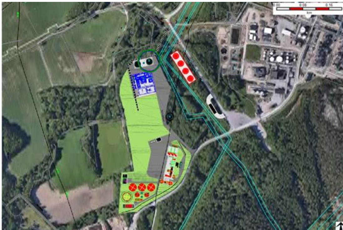
Figur 6-32: Påverkansområdet för cisternbrand för väder 2/F och 5D. I figuren visas endast avstånd till 6 kW/m 2 . Grön markering = 6 kW/m 2 vid väder 5/D, blå markering = 6 kW/m 2 vid väder 2/F.
