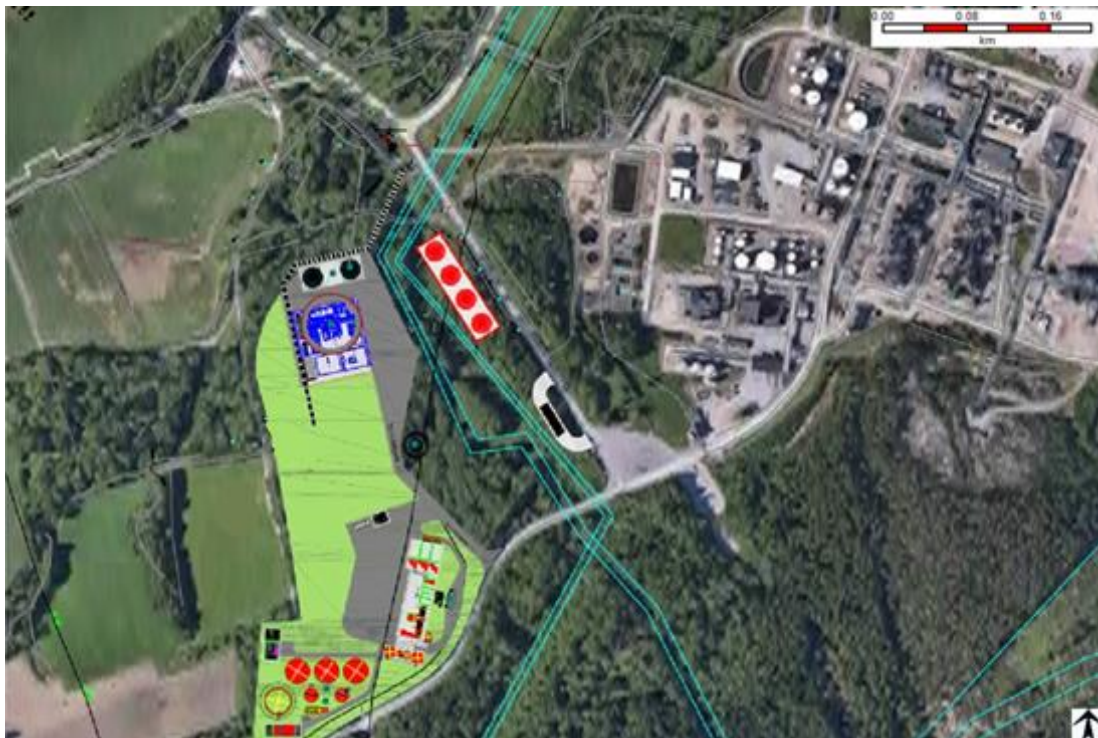
Figur 6-35: Möjligt påverkansområde för gasmolnexplosion för väderförhållande 5/D. Grå ring = 0,21 bar(g), röd ring = 0,14 bar(g).
