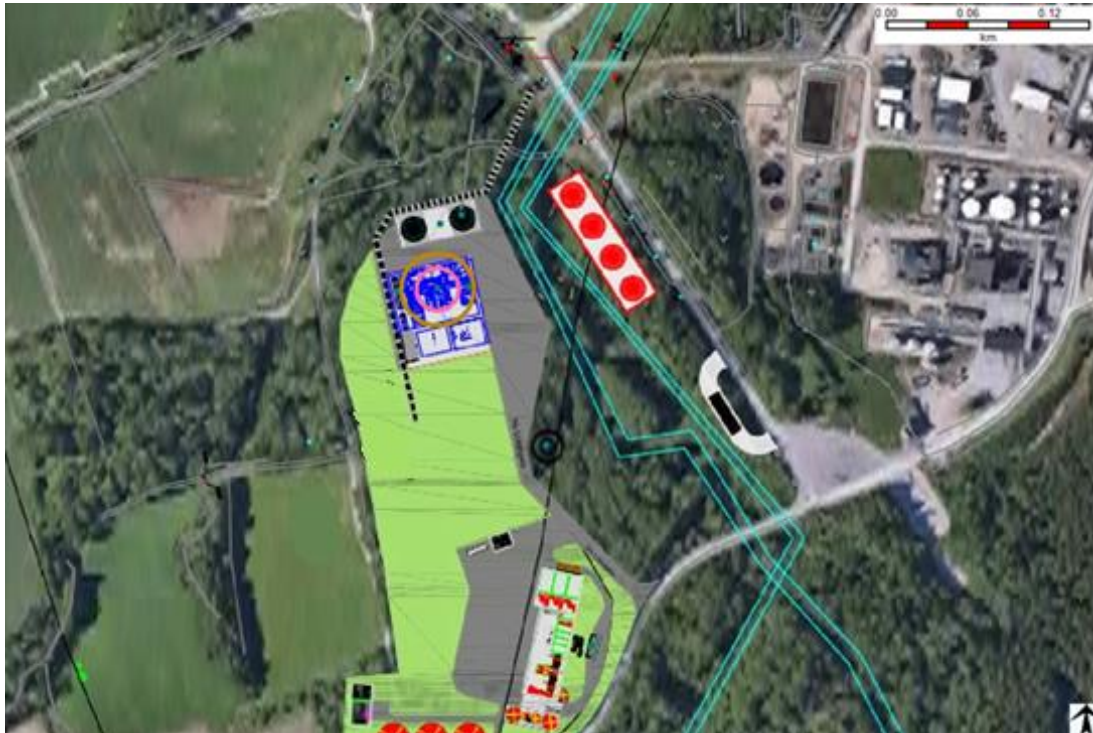
Figur 6-37: Möjligt påverkansområde för jetbrand för väderförhållande 5/D. Orange ring = 6 kW/m 2 , rosa ring = 37,5 kW/m 2 .
