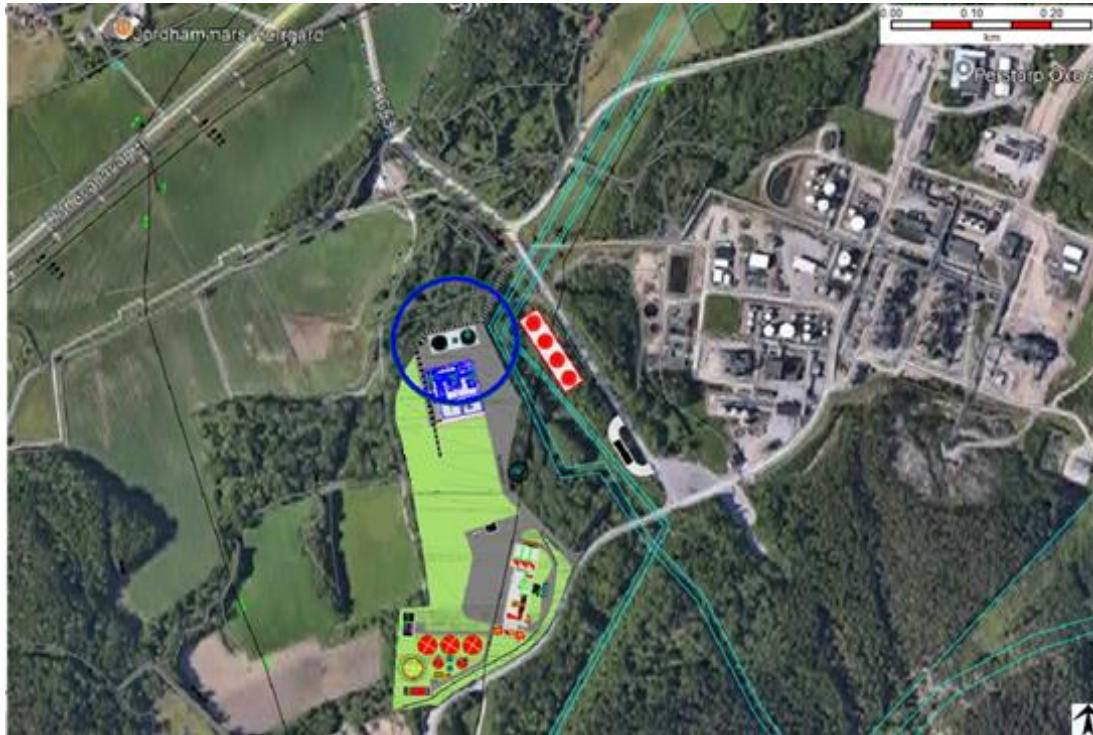
Figur 6-29: Påverkansområdet för pölbrand i invallning för väder 2/F och 5D. I figuren visas endast avstånd till 6 kW/m 2 . Grön markering = 6 kW/m 2 vid väder 5/D, blå markering = 6 kW/m 2 vid väder 2/F.
