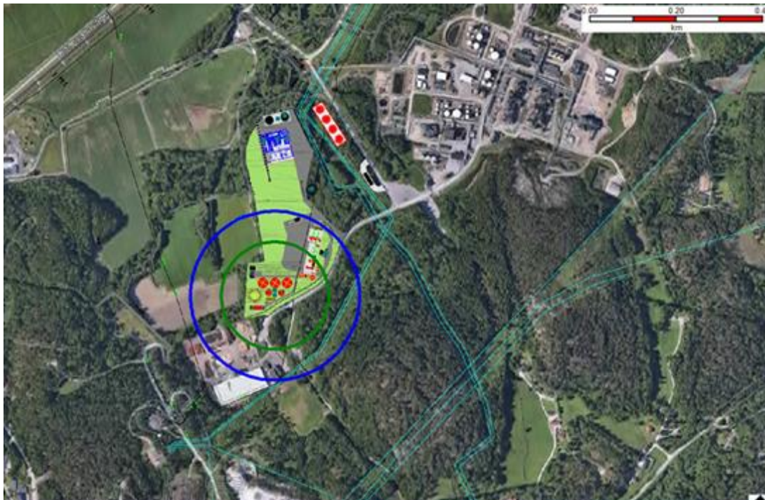
Figur 6-23: Det möjliga påverkansområdet för läckage av ammoniak för väderförhållande 2/F. Blå ring = AEGL-2 (220 ppm), grön ring = AEGL-3 (1600 ppm).
