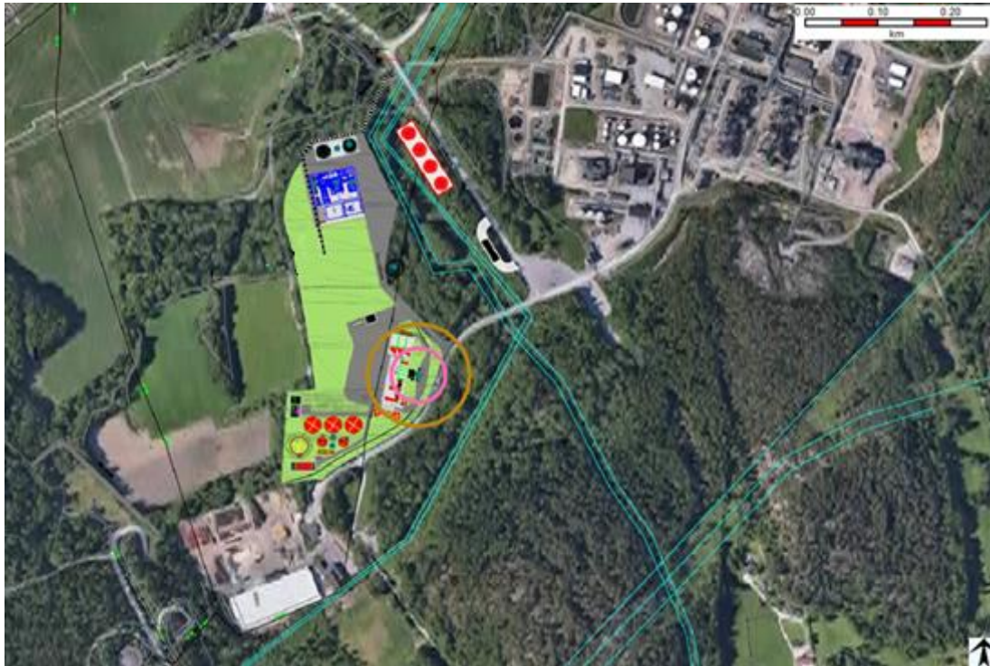
Figur 6-7: Möjligt påverkansområde för pölbrand för väderförhållande 5/D. Orange ring = 6 kW/m 2 , rosa ring = 37,5 kW/m 2 .
