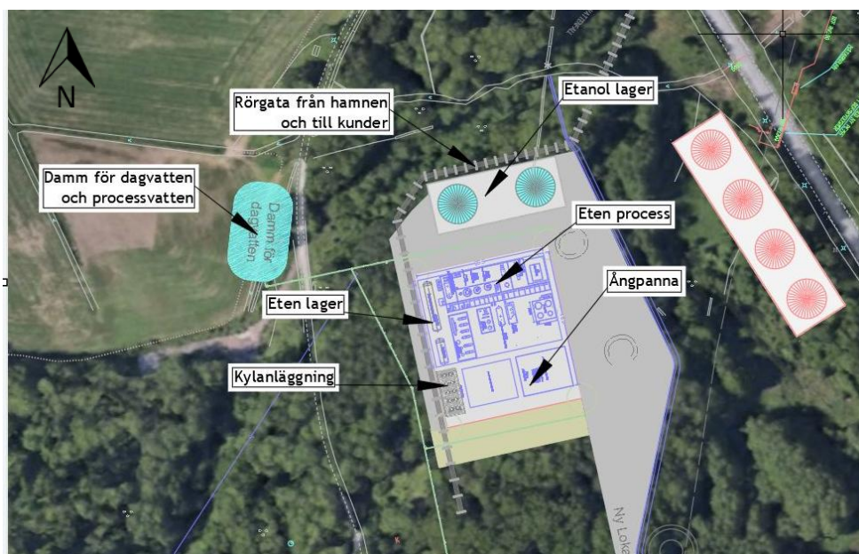
FIGUR 6 ÖVERSIKTLIG PRELIMINÄR LAYOUT FÖR BIOETENANLÄGGNINGEN.
